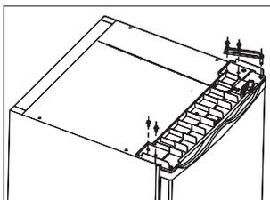
3. Soulevez la porte et placez-la sur une surface rembourrée pour éviter de la rayer. Retirez les pieds ajustables et retirez la charnière du bas en défilant les vis. Transférez le tout du côté opposé.
