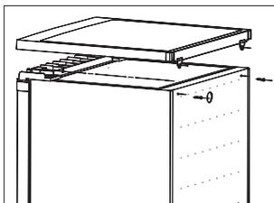
2. Retirez les quatre vis en respectant le diagramme suivant. Soulevez le gond supérieur, puis mettez-le de côté.
